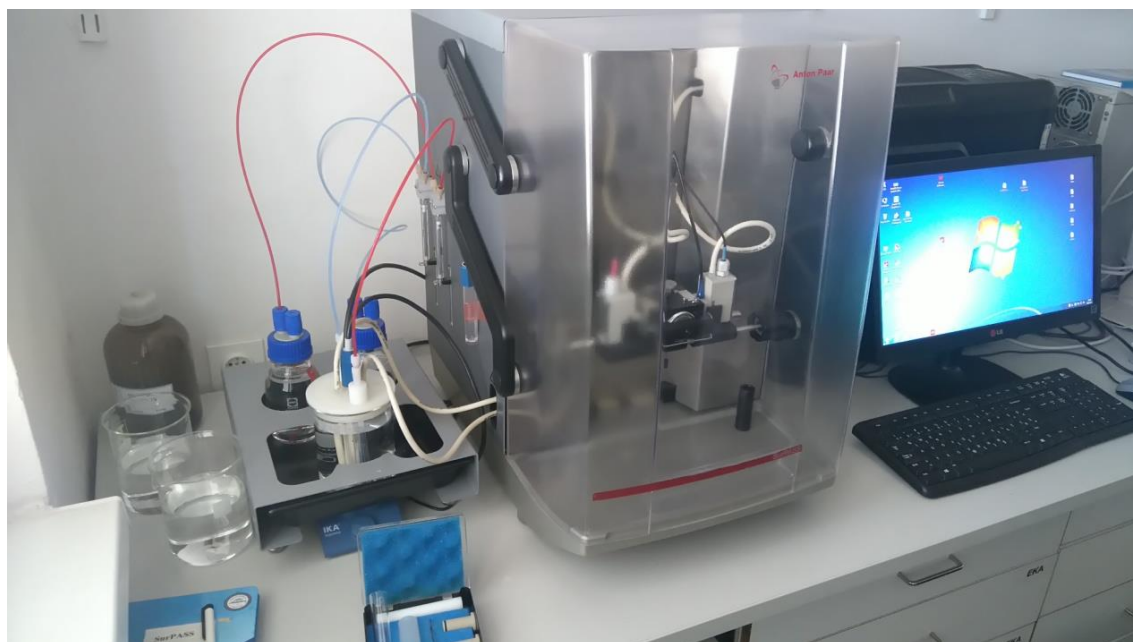
Slika 12. SurPASS, uređaj za mjerenje zeta potencijala
