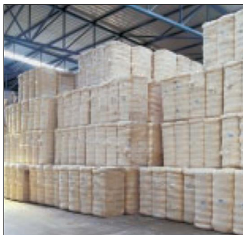
Slika 3: Vlakna pakirana u balama [4]
