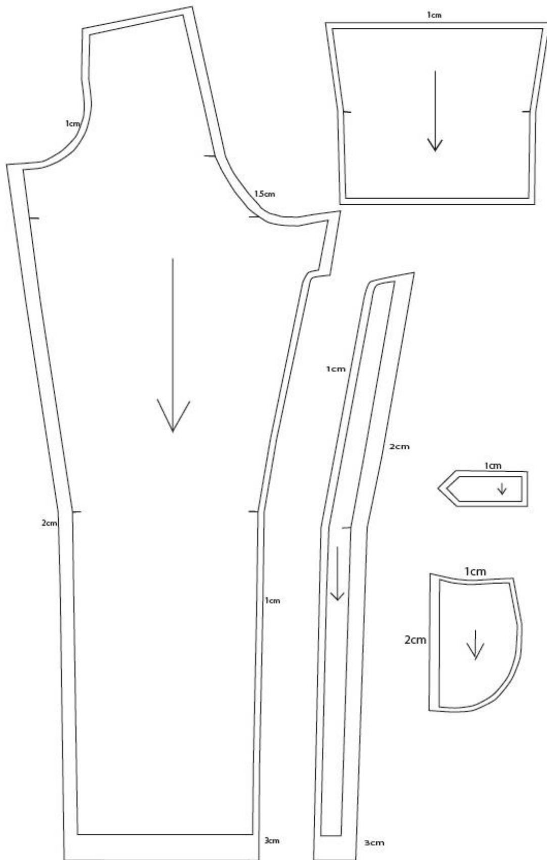
Slika 13. – Krojni dijelovi sa dodanim šavnim dodacima za stražnji dio lovačkih hlača
