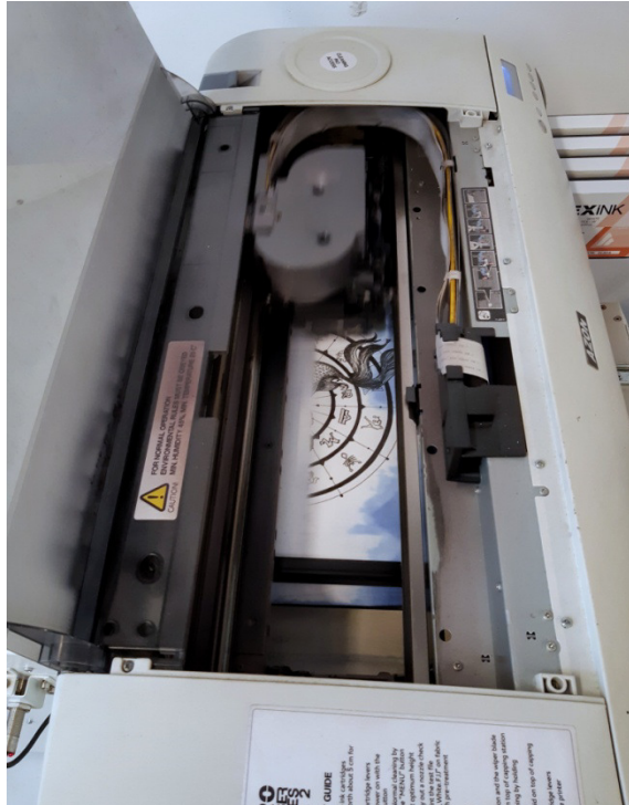
Slika 42: Proces tiskanja na Inkjet Azon TexPro Series2 printeru
