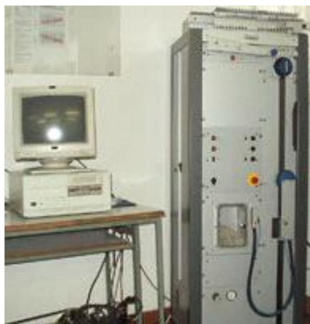
*Slika 9. Dinamometar STATIMAT M- t.t. Textechno, Njemačka*
