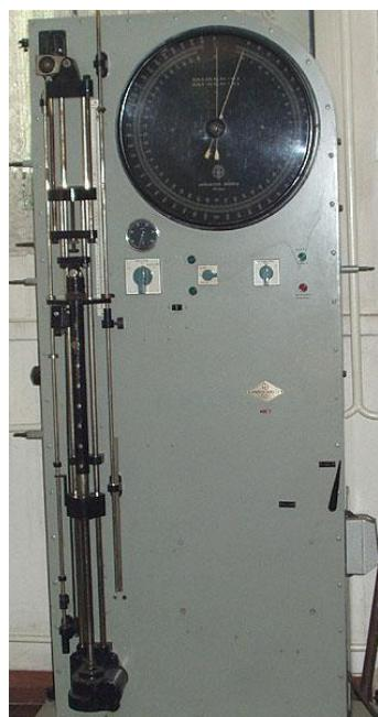
*Slika 10. Dinamometar Apparecchi Branaca S.A., Italija*
