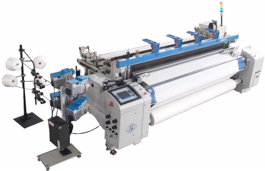
Sl. 28. Stroj za tkanje sa zračnim mlazom, IZVOR: www.texindex.com
