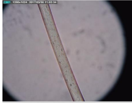
Slika 29. Mikroskopiranje vlakana u zagrijanom ClZnI
