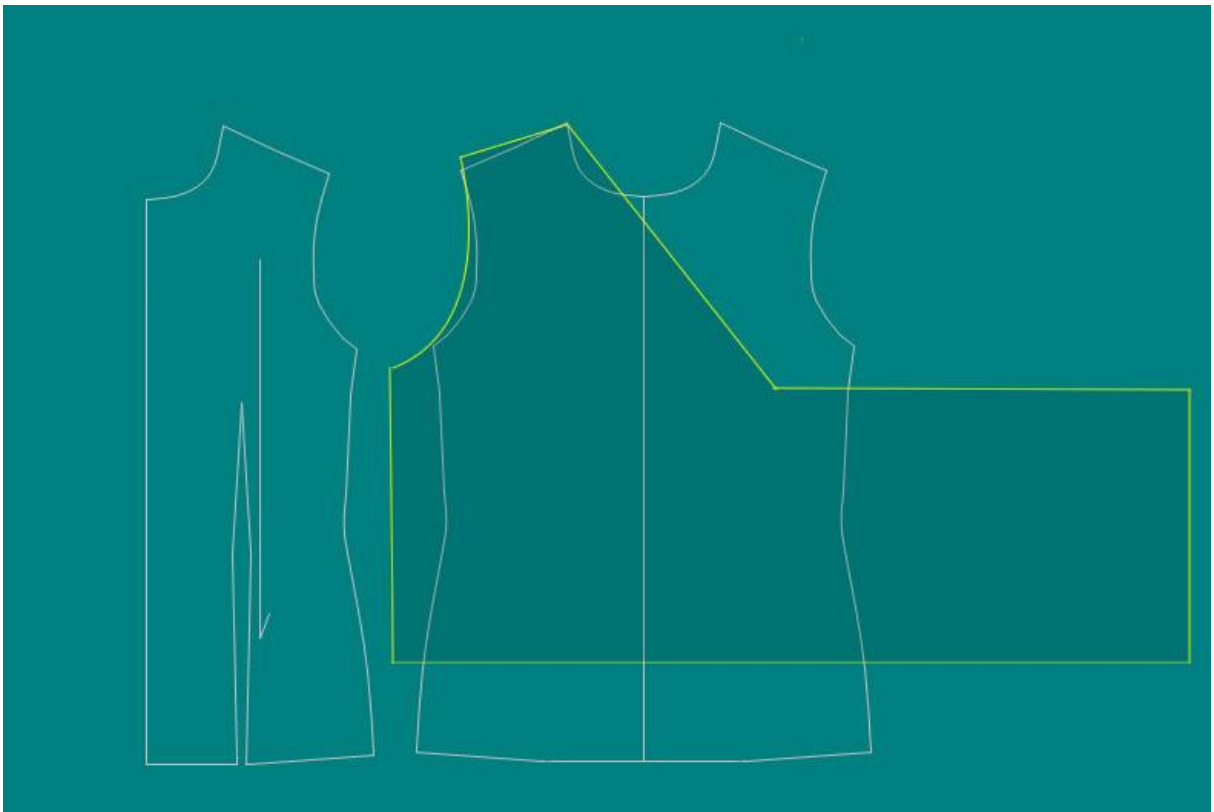
Slika 26. Modeliranje prednjeg dijela jakne
