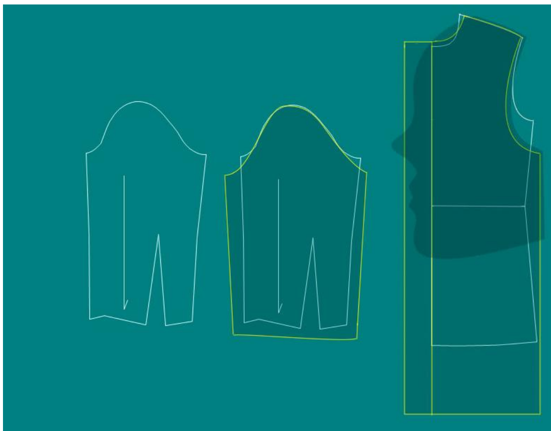
Slika 21. Modeliranje rukava i prednjeg prsnog dijela
