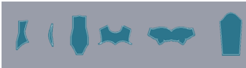
Slika 21: Modelirani krojni dijelovi prednjeg dijela s dodanim šavnim dodatcima
