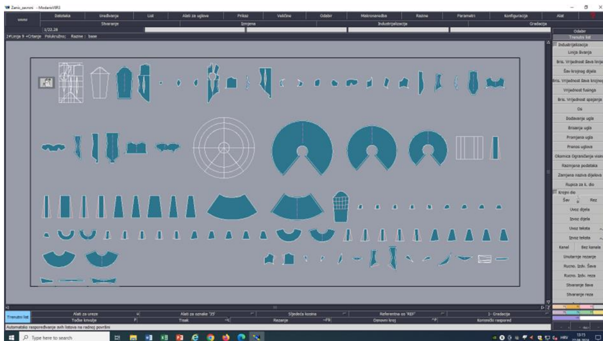
Slika 31: Prikaz krojnih dijelova sa šavnim dodatcima i referentnom osi
