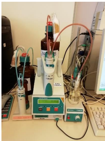
Slika 25: Auto – titrator 736 GP Titrino (Methrom)
