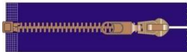
Sl. 14. Zupci metalnog zatvarača
