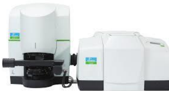
Slika 26. Mikroskop uparen s FTIR spektroskopom
