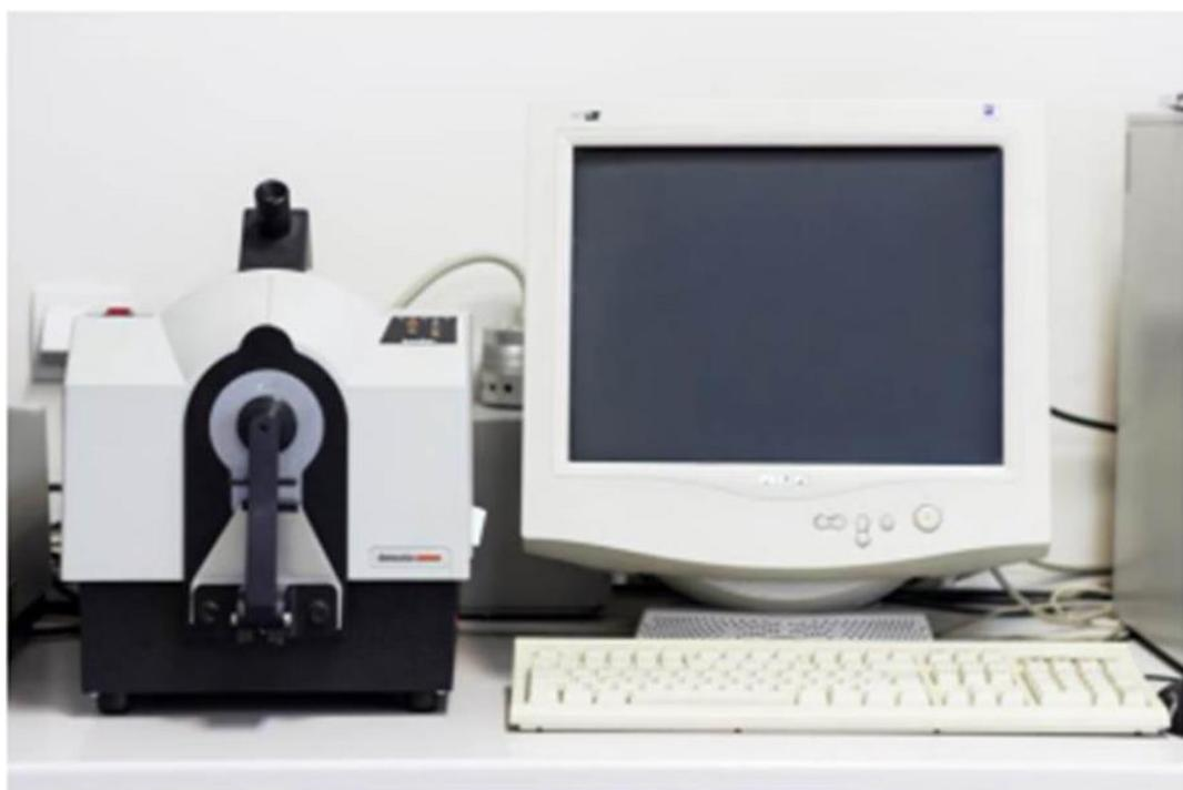
**Slika 15.** Remisijski spektrofotometar DataColor SP600 + CV UV [8]
