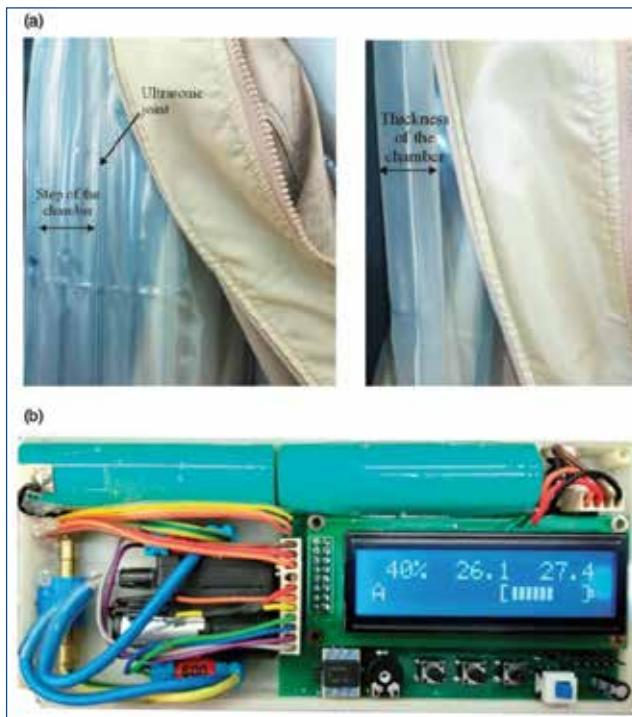
Inteligentna odjeća s adaptivnim svojstvima toplinske izolacije: (a) termoizolacijske komore između vanjske školjke i podstave; između vanjske ovojnica i obloge; (b) elektroničke i pneumatske komponente smještene u posebnoj vodootpornoj kutiji
