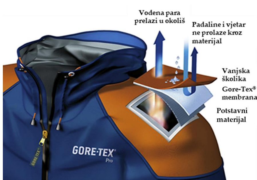
Sl. 6: Primjer primjene Gore-Tex membrane (Gore-tex, 2022)
