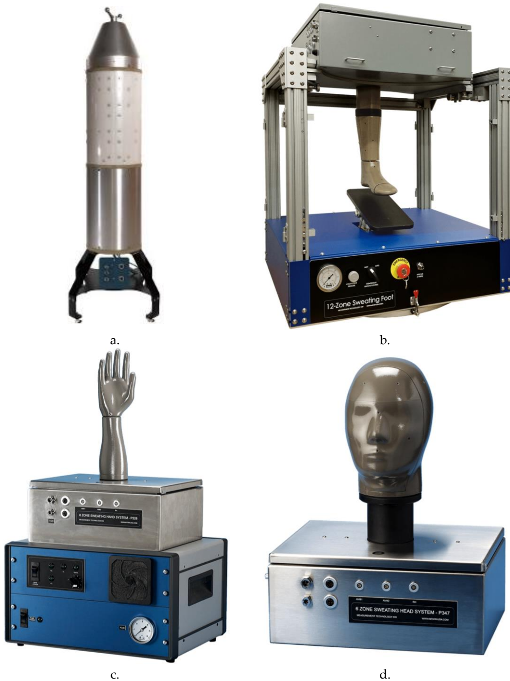
Sl. 12: Prikaz anatomski oblikovanih mjernih uređaja za mjerenje toplinske izolacije: a. toplinski torzo; b. toplinsko stopalo; c. toplinska ruka i d. toplinska glava (Thermetrics, 2020)
