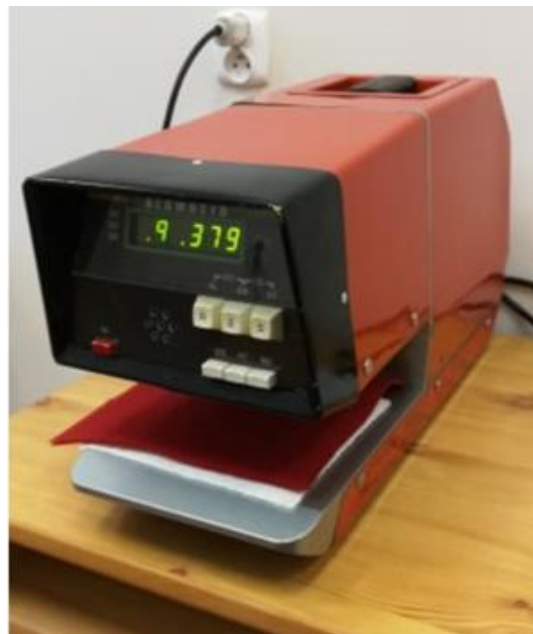
Sl. 10: Prikaz Alambeta mjernog uređaja (Kaziur et al., 2022)
