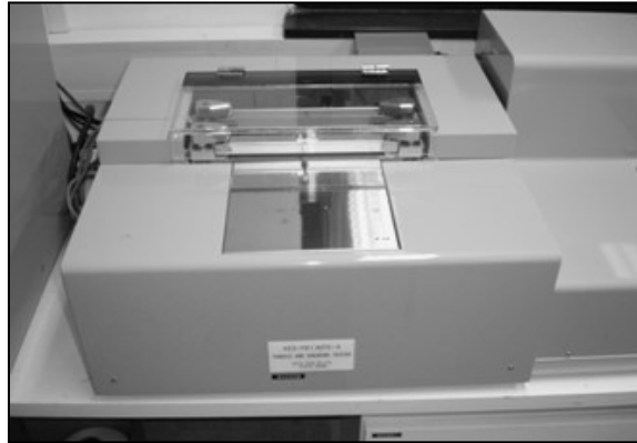
Sl. 3.12 KES-FB1 mjerni uređaj za mjerenja vlačnih i smičnih svojstava
