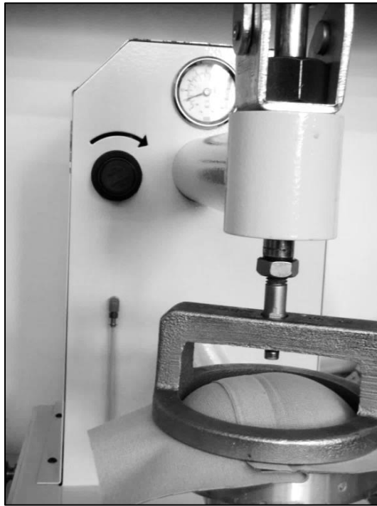
Sl. 3.24 Prikaz uređaja za ispitivanje vodonepropusnosti spojeva
