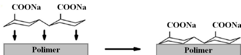
Slika 22 Shematski prikaz adsorpcije CMC na površinu polimera [103]
