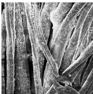
Slika P7.18 Mikrografi oprane PT tkanine u laboratorijskoj uređaju Polymat s deterdžentom uz dodatak CMC, u mekoj i tvrdoj vodi na 90 °C kroz 11 ciklusa uz povećanja a. i d. 1000x, b. i e. 2000x te c. i f. 5000x
