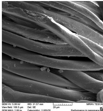
Slika P7.7 Mikrografi oprane PT tkanine u laboratorijskoj perilici s deterdžentom uz dodatak kombinacije CMC+CMS, u mekoj i tvrdoj vodi na 40 °C kroz 11 ciklusa uz povećanja a. i d. 1000x, b. i e. 2000x te c. i f. 5000x
