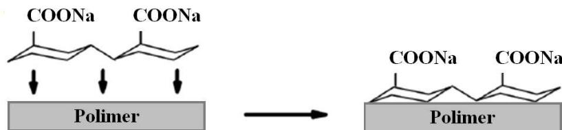
Slika 22 Shematski prikaz adsorpcije CMC na površinu polimera [103]
