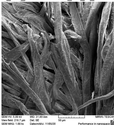
Slika P7.8 Mikrografi oprane PT tkanine u laboratorijskoj perilici s deterdžentom uz dodatak kombinacije CMC+CMS, u mekoj i tvrdoj vodi na 60 °C kroz 11 ciklusa uz povećanja a. i d. 1000x, b. i e. 2000x te c. i f. 5000x
