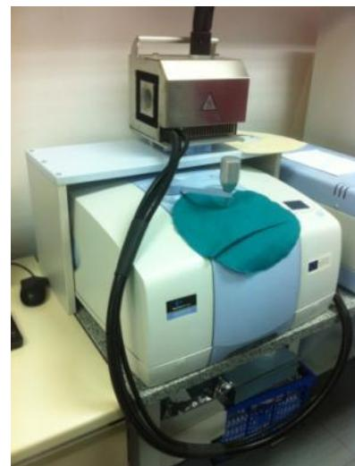
**Slika P6.8.** Spectrum 100S FT-IR UATR + TG/IR Interface TL8000 (RedShift), Perkin Elmer
