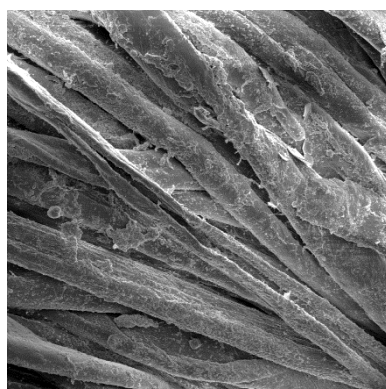
Slika P7.23 Mikrografi oprane PT tkanine u laboratorijskoj uređaju Polymat s deterdžentom uz dodatak kombinacije CMC+CMS, u mekoj i tvrdoj vodi na 60 °C kroz 11 ciklusa uz povećanja a. i d. 1000x, b. i e. 2000x te c. i f. 5000x
