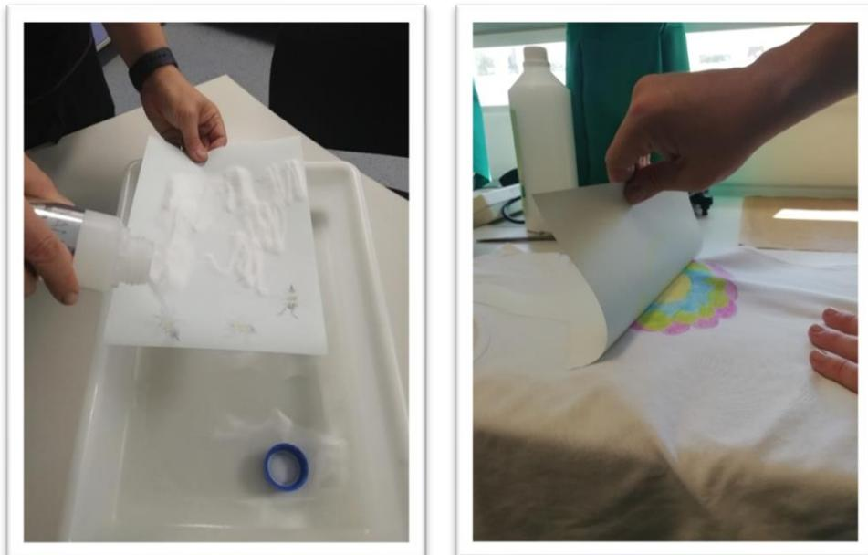
Slika 7 i 8: posipavanje stabilizacijskog praha i uklanjanje transfer papira [28]
