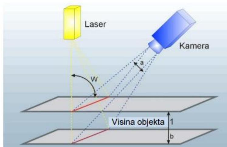
Slika 10: Sustav kamere i lasera koji se koristi za snimanje 3D skenerom - princip optičke triangulacije [24]
