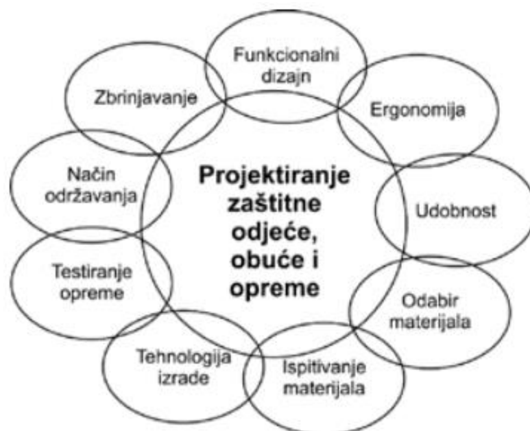
Slika 1: Čimbenici koji utječu na projektiranje zaštitne odjeće, obuće i opreme [7]
