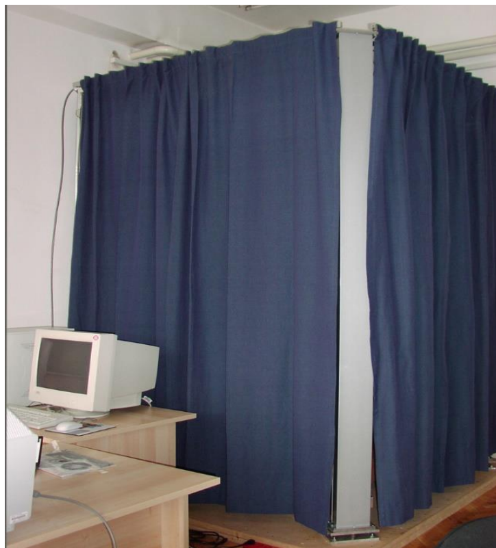
Slika 11: 3D body skener Vitus Smart
