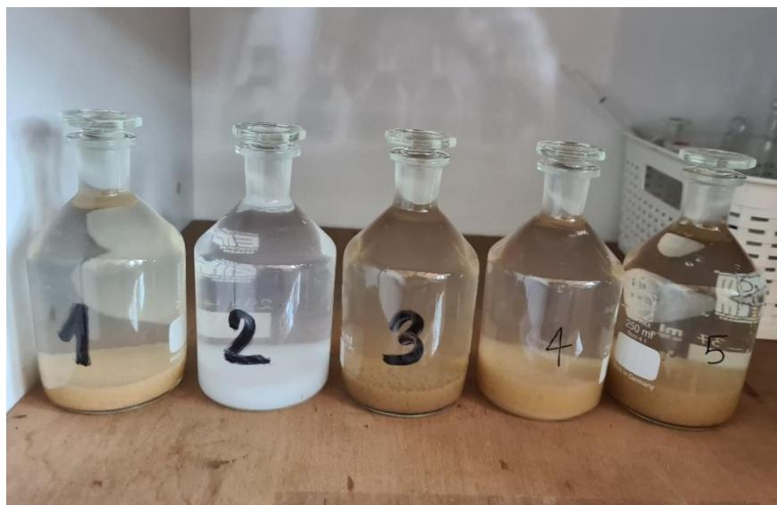
**Slika 16.** Uzorci za izpitivanje- 5. dan (Winklerova metoda)
