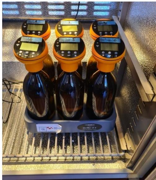
Slika 11. OxiTop mjerni sustav
