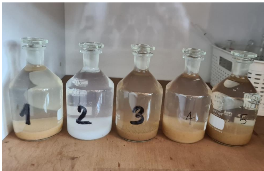
Slika 16. Uzorci za izpitivanje- 5. dan (Winklerova metoda)
