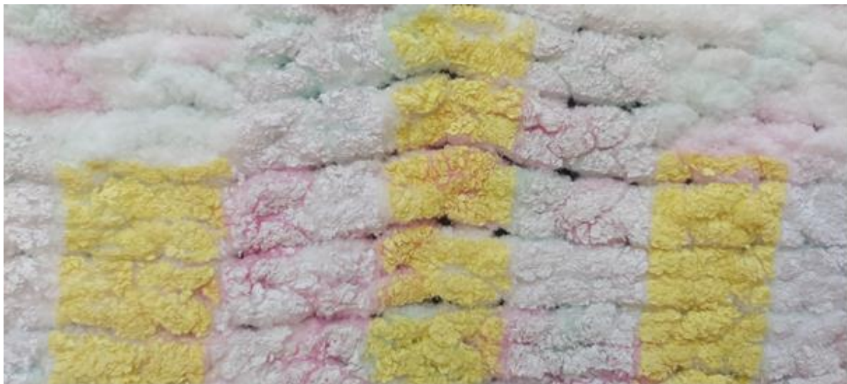
Slika 31.b. Izgled otiska na uzorku br.6 pletiva prilikom rastezanja pletiva [44]
