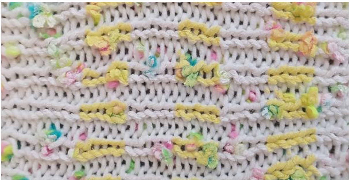
Slika 29.b. Izgled otiska na uzorku br.4 pletiva prilikom rastezanja pletiva [40]
