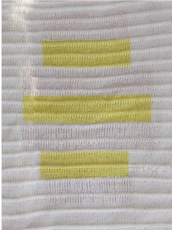
Slika 26.a. Dvobojni otisak tehnikom sitotiska na uzorku br.1 pletiva u opuštenom stanju [33]
