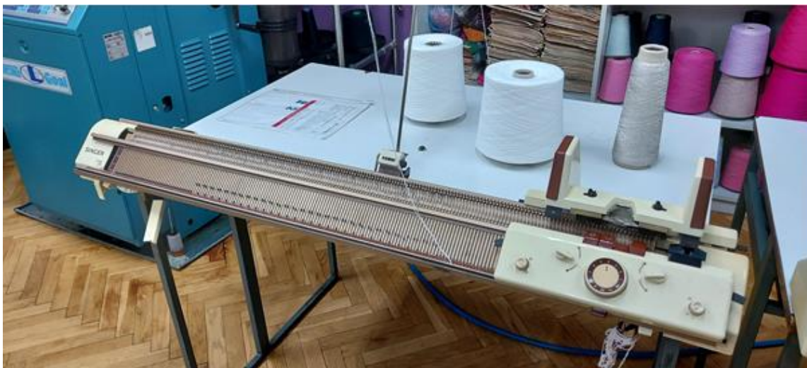
Slika 12. Ravnopletaći stroj na Tekstilno-tehnološkom fakultetu u Zagrebu [13]
