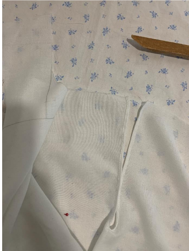
Slika 28 Završni porubni šav, presjeka na prednjici
