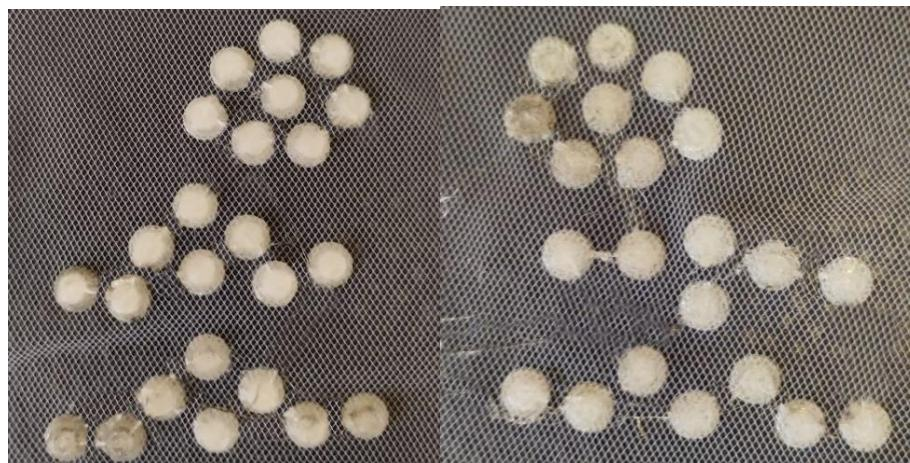
Slika 41. Ojačanja 3D tiskana TPU filamentom
