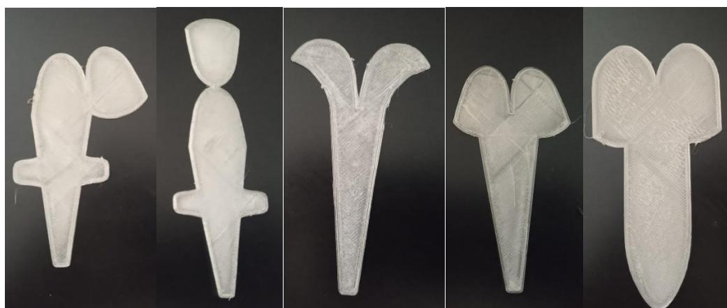
Slika 31. 3D tiskana ojačanja konstruirana i modelirana iz jednog dijela
