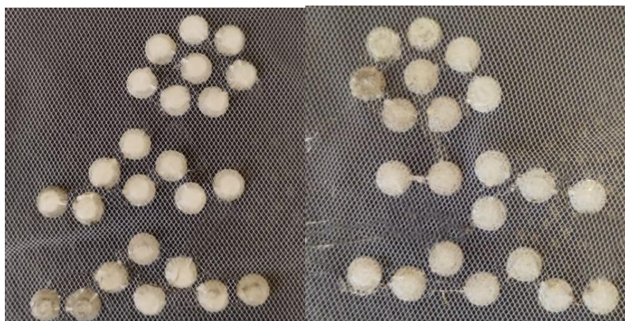
Slika 41. Ojačanja 3D tiskana TPU filamentom
