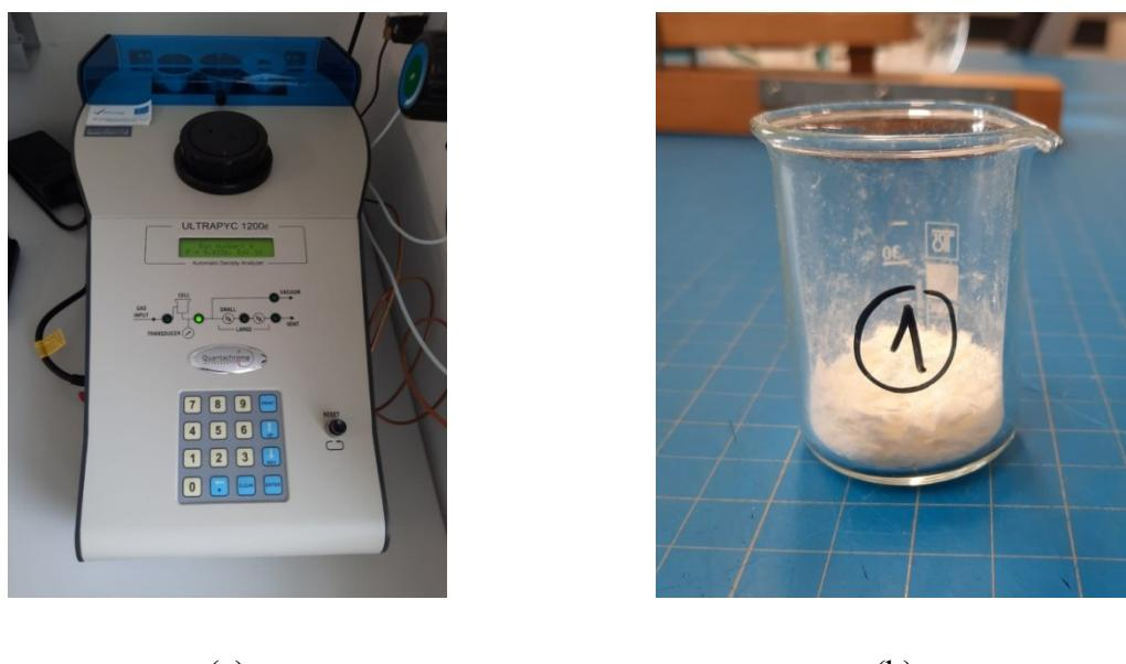
**Slika 27:** Ispitivanje svojstva gustoće na uređaju (a) plinski piknometar Ultrapyc 1200e uz (b) prethodno vaganje uzorka koji mora ispuniti  $\frac{3}{4}$  volumena tuljca u kojem se vrši ispitivanje
