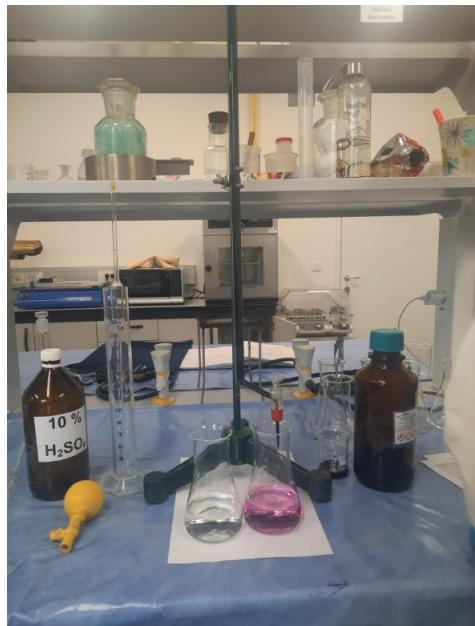
**Slika 23:** Aparatura za titraciju
