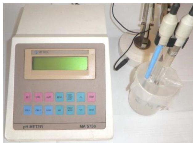
**Slika 21:** pH metar za određivanje pH vrijednosti kupelji
