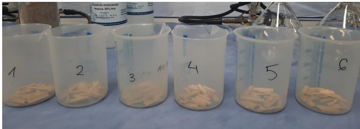
**Slika 16:** Ručno usitnjeni uzorci rezanjem sa skalpelom pripremljeni za obradu u kupeljima K1-K6
