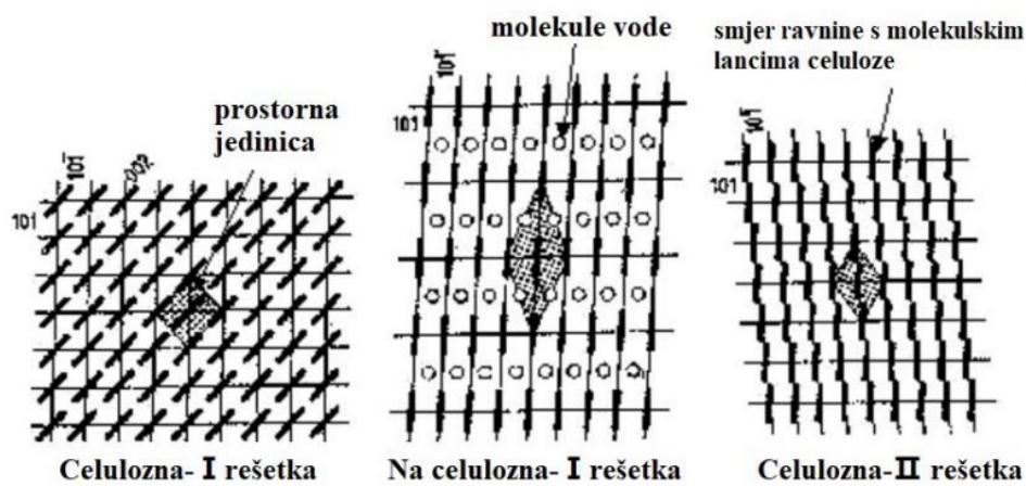
Slika 7. Shematski prikaz djelovanje NaOH na prirodu celulozne rešetke [38]
