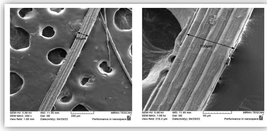
**Slika 32.** SEM snimka uzdužnog presjeka vlakna SH
