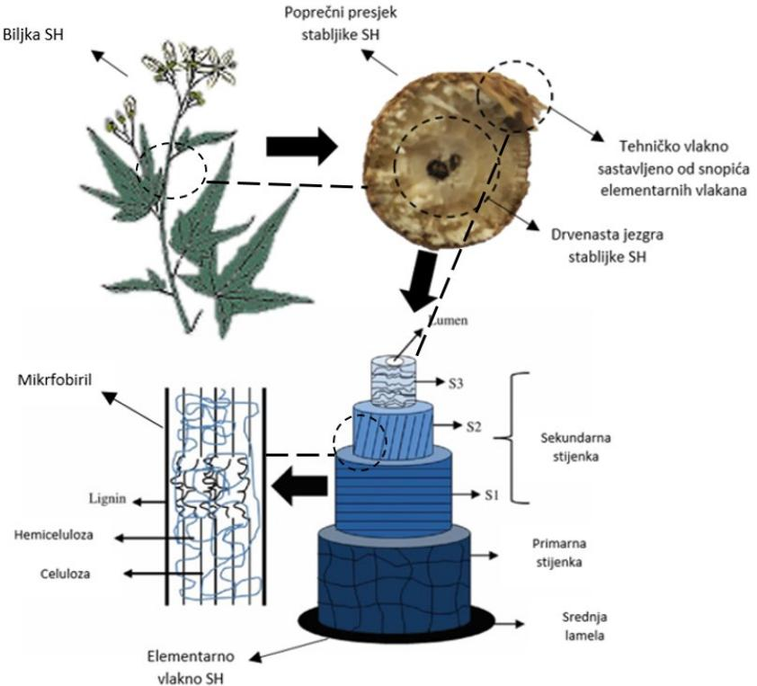
**Slika 12.** Prepostavljeni prikaz strukture stabljičnog vlakna SH od biljke, stabljike do elementarnog vlakna
