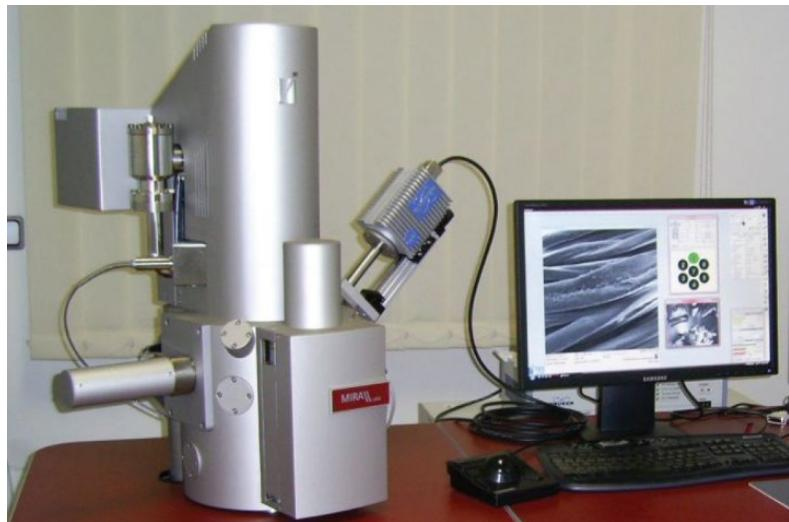
**Slika 19.** Skenirajući elektronski mikroskop FE-SEM//Mira, Tescan [65]
