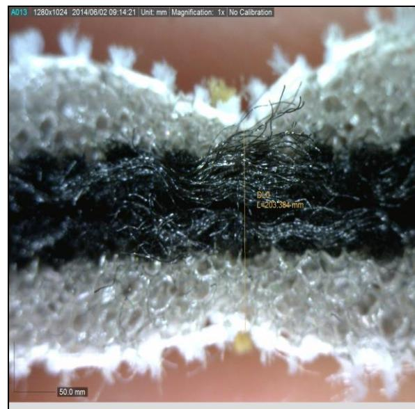
Sl. 114 Poprečni presjek kompozita na
