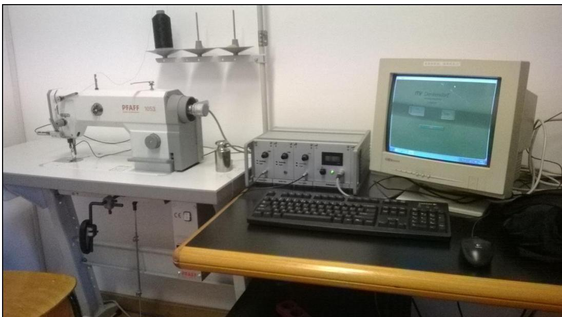
Sl.61 Mjerni uređaj za mjerjenje probodne sile šivaće igle na šivaćem stroju koji se nalazi na Tekstilno-tehnološkom fakultetu u Sveučilištu u Zagrebu
