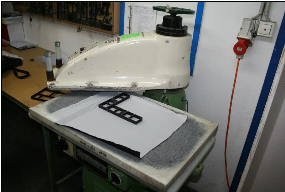
Sl. 53 Priprema uzorka za ispitivanje
