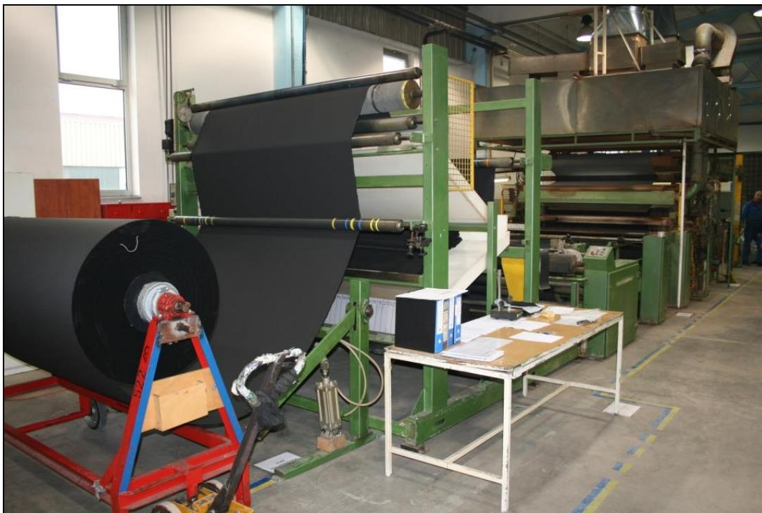
Sl. 52 Stroj za lijepljenje komponenata u kompozit sa plinskim plamenikom tt. Schmid,
