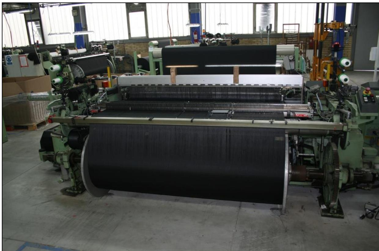
Sl.50 Tkalački stroj sa unosom potke pomoću hvatala i elektronskom listovkom
