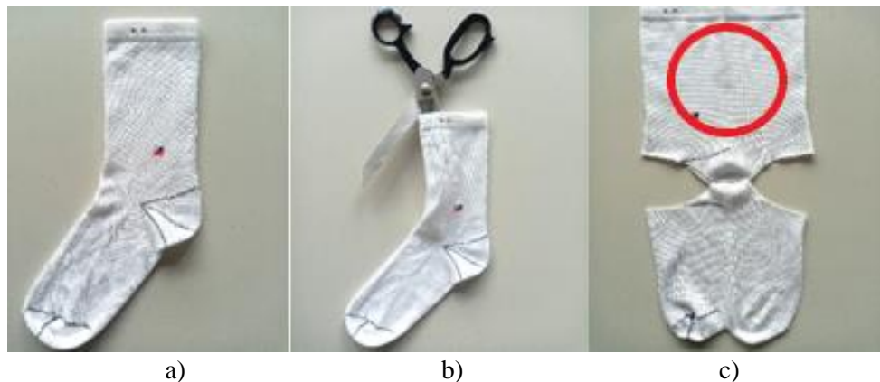
Slika 18. Priprema uzorka čarape za ispitivanje: a) cijela čarapa, b) razrezivanje čarape, c) čarapa pripremljena za uzorkovanje pletiva (crveni krug – uzorak za ispitivanje pilinga)
