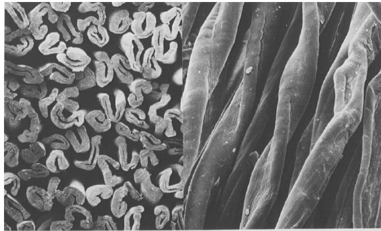
Slika 4. Poprečni presjek i uzdužna slika pamučnih vlakana (skenirajući elektronski mikroskop) [5]
