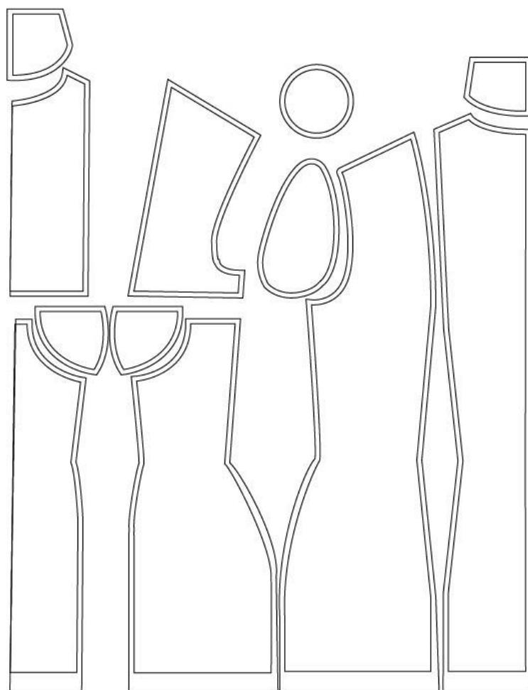
**Slika 39. Krojni dijelovi krojačke lutke sa šavnim dodacima (autorski rad)**
