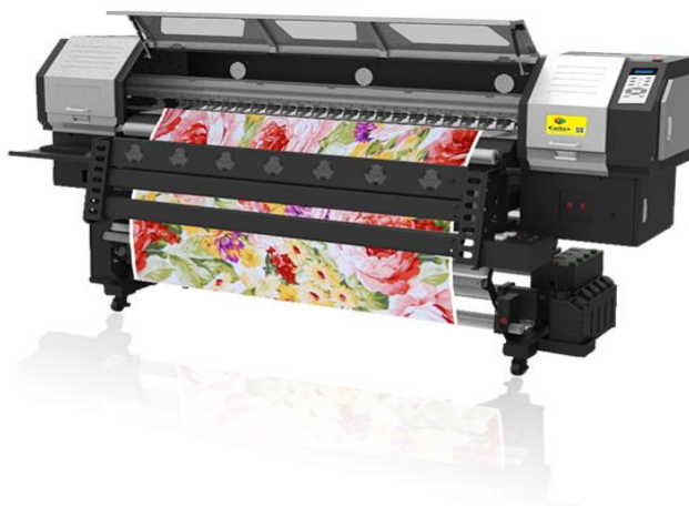
Slika 12: Digitalni pisač sa sublimacijskim bojilima
