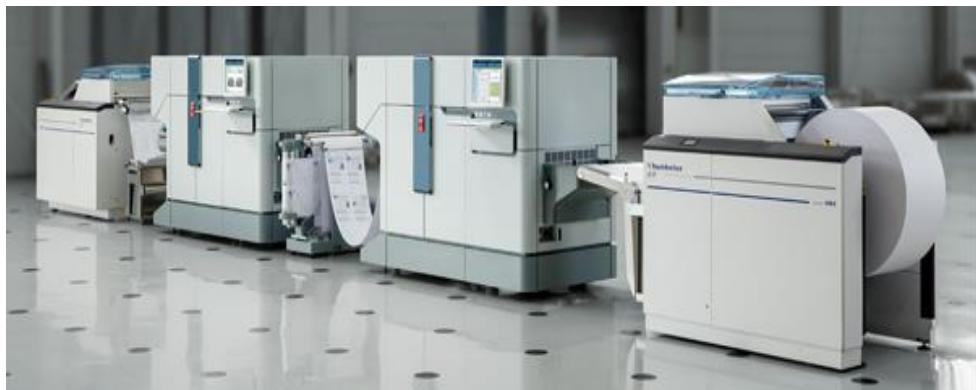
**Slika 1:** Sustav digitalnog tiska na pamučni tekstilni materijal
