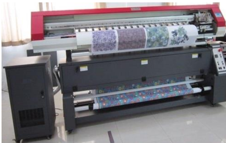
Slika 2: Digitalni stroj za sublimacijski tisak
