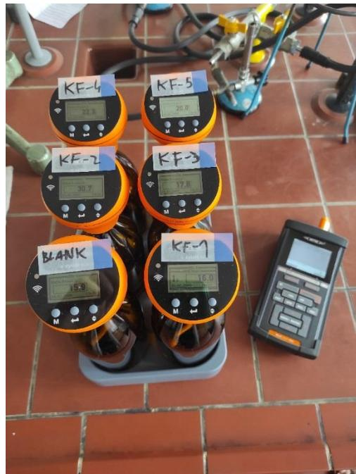
**Slika 3.9.** OxiTop set za mjerjenje BPK vrijednosti u trenutku kada je mjerjenje završeno
