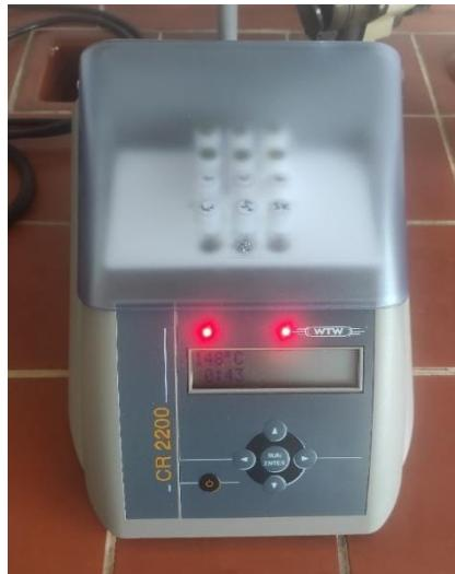
**Slika 3.3.** Termoreaktor u kojem se provodi reakcija refluksiranja
