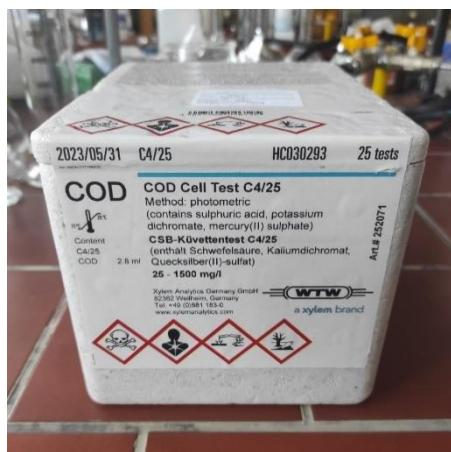
**Slika 3.3. Kutija sa kivetama za provođenje mjerena KPK vrijednosti**
