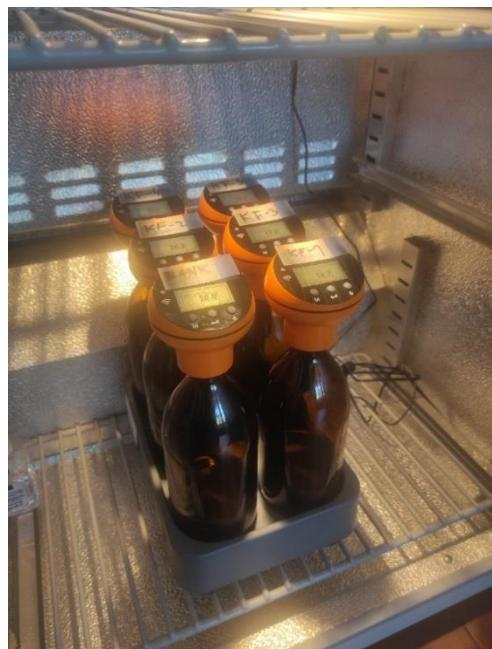
**Slika 3.8.** OxiTop set za mjerjenje BPK vrijednosti u inkubatoru
