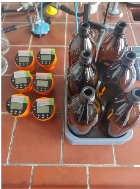
Slika 3.6. OxiTop set za mjerenje BPK vrijednosti
