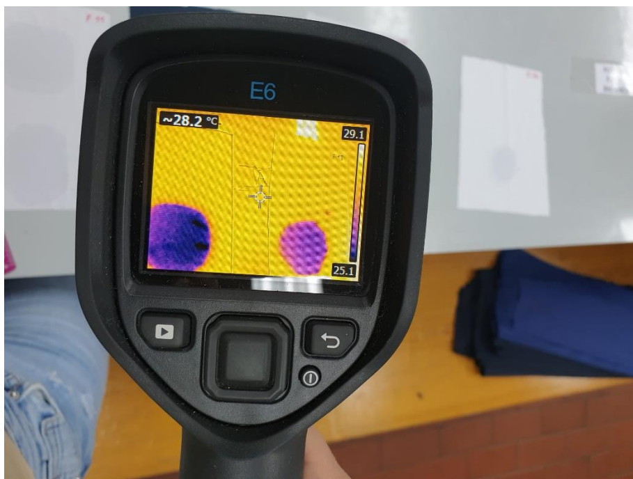
Sl. 10. Ispitivanje materijala termalnom kamerom
