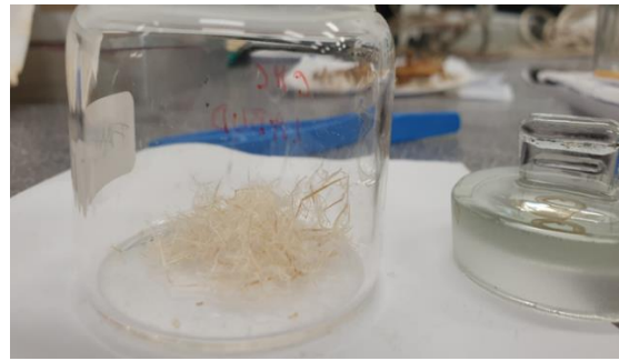
Slika 16. Uzorak Miscanthus x giganteus obrađen u Kupelji 3 gdje je a) uzorak nakon sušenja i filtracije i b) izolirana vlakna iz uzorka
