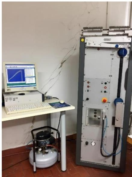
**Sl. 4.** Dinamometar Statimat M-tt. Textechno, Njemačka
