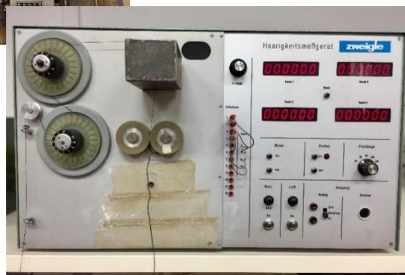
**Sl. 5.** Uređaju za mjerjenje dlakavosti pređe tip G 565 tt. Zweigle, Njemačka
