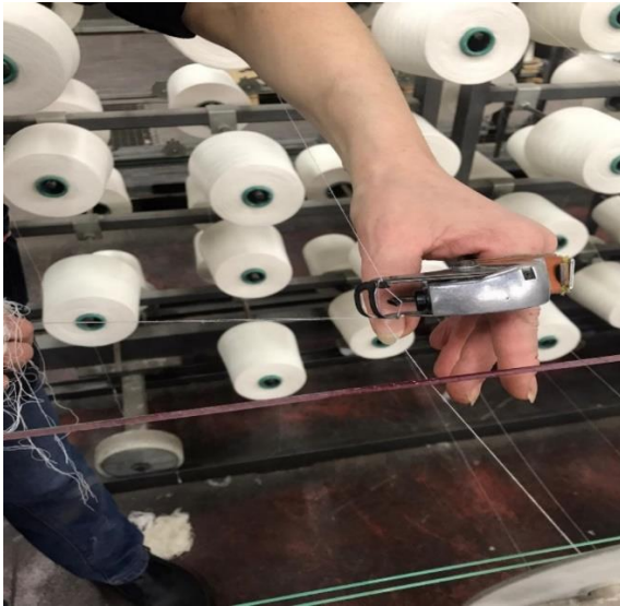
Sl. 14. Spajanje niti ručnim vezačem
