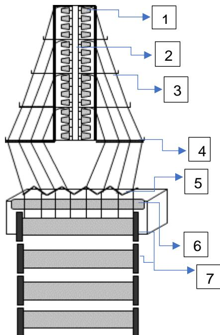
**Sl. 2.** Englesko snavanje: 1 – namotak, 2 – stalak za namotke, 3 – vodiči niti, 4 – čuvare niti, 5 – ekspanzijski češalj, 6 – prevojnik, 7 – snovači valjci [4]
