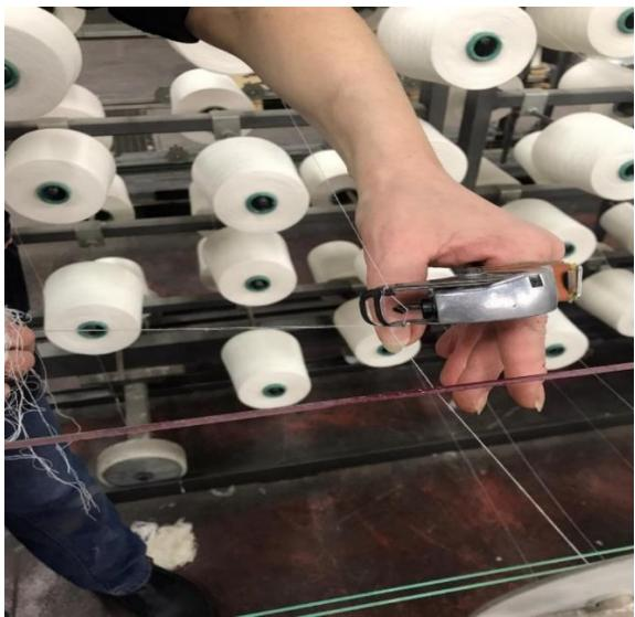
**Sl. 14.** Spajanje niti ručnim vezačem
