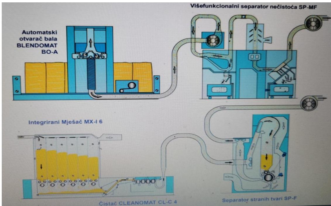
*Slika 1 Kompaktna linija 1. faze za preradu vlakana (otvaranje, čišćenje i mješanje) tt. Trutzschler [9]*
