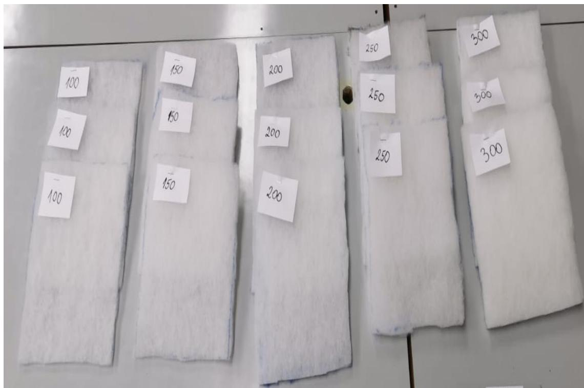
Slika 10 Izrezani uzorci različitih površinskih masa spremni za vaganje i mjerjenje debljine
