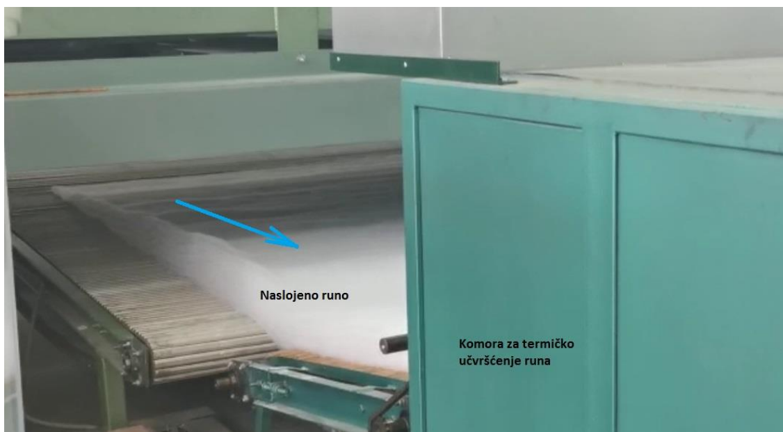
Slika 11 Termičko učvrščenje runa
