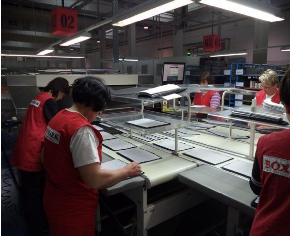
Slika 10 Ulaz krojnih dijelova u termo kanal radi aktiviranja ljepila za laminiranje
