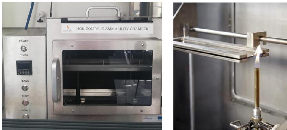
**Slika 8 – Horizontalna komora za ispitivanje gorivosti (Concept Equipment)**
