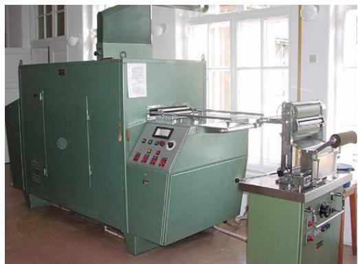
Slika 7 - Rastezni sušionik i foulard tt. Benz
