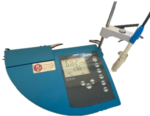
Sl. 12. Konduktometar CG 853, Schott
