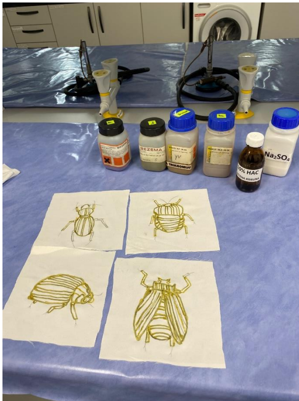
Slika 25: Prikazuje uzorke svile izrezane na 16x16 cm sa korištenim bojilima, octenom kiselinom i natrijevim sulfatom
