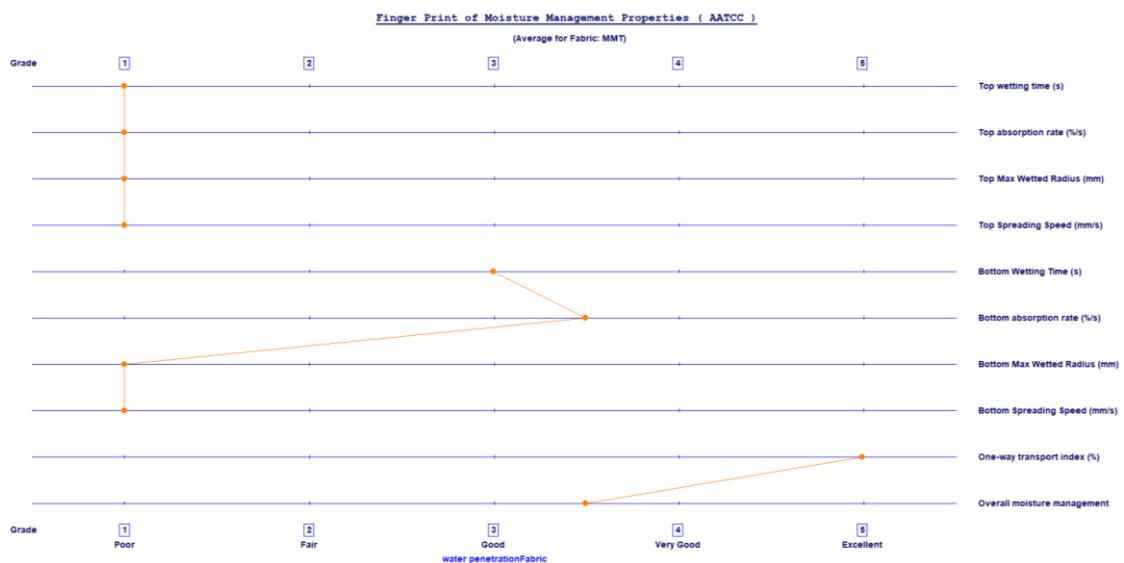
Slika 32. Fingerprint uzorka standardne poliesterske tkanine obradjenog u otopini enzima koncentracije 0,2 g/L, pH vrijednosti 7 te u vremenu obrade od 30 minuta
