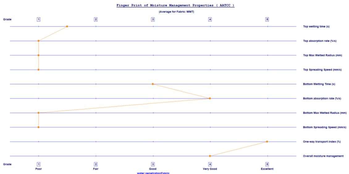
Slika 41. Fingerprint uzorka standardne poliesterske tkanine obradjenog u otopini enzima koncentracije 0,2 g/L, pH vrijednosti 9 te u vremenu obrade od 60 minuta
