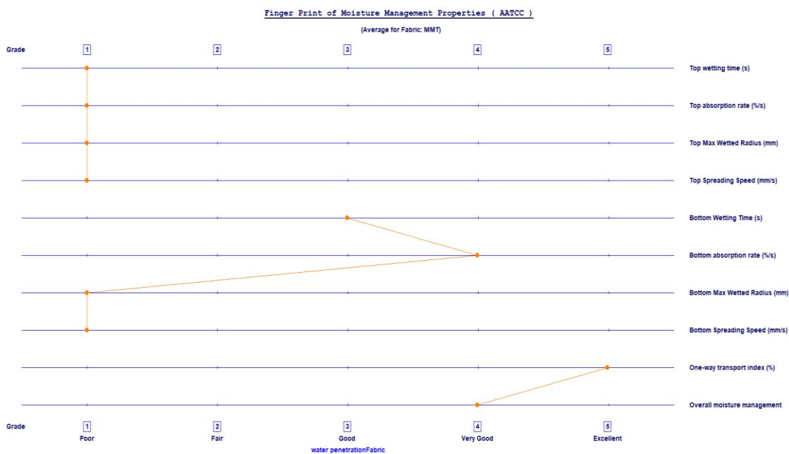
Slika 27. Fingerprint uzorka standardne poliesterske tkanine obradjenog u otopini enzima koncentracije 0,1 g/L, pH vrijednosti 7 te u vremenu obrade od 15 minuta
