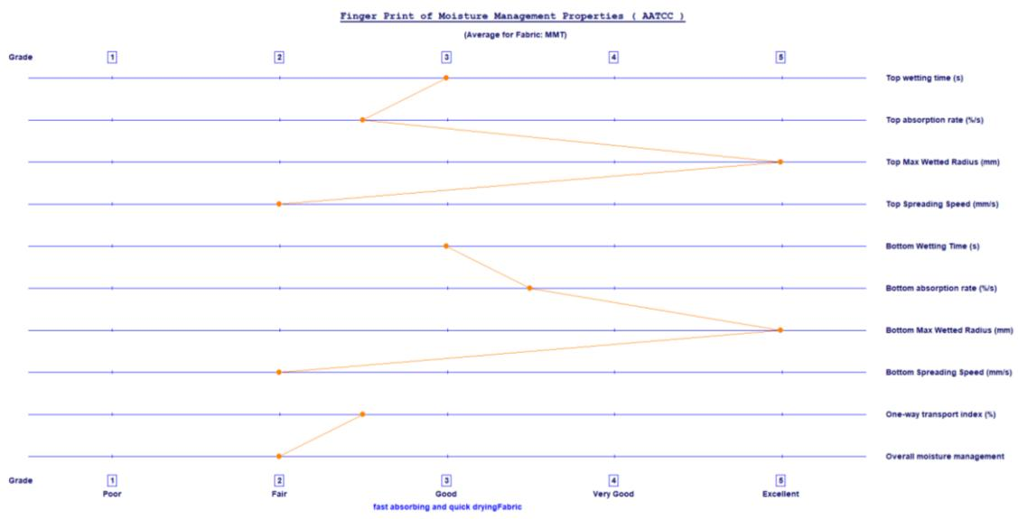
Slika 86. Fingerprint uzorka komercijalne poliesterske tkanine obrađenog u otopini enzima koncentracije 0,1 g/L, pH vrijednosti 9 te u vremenu obrade od 120 minuta
