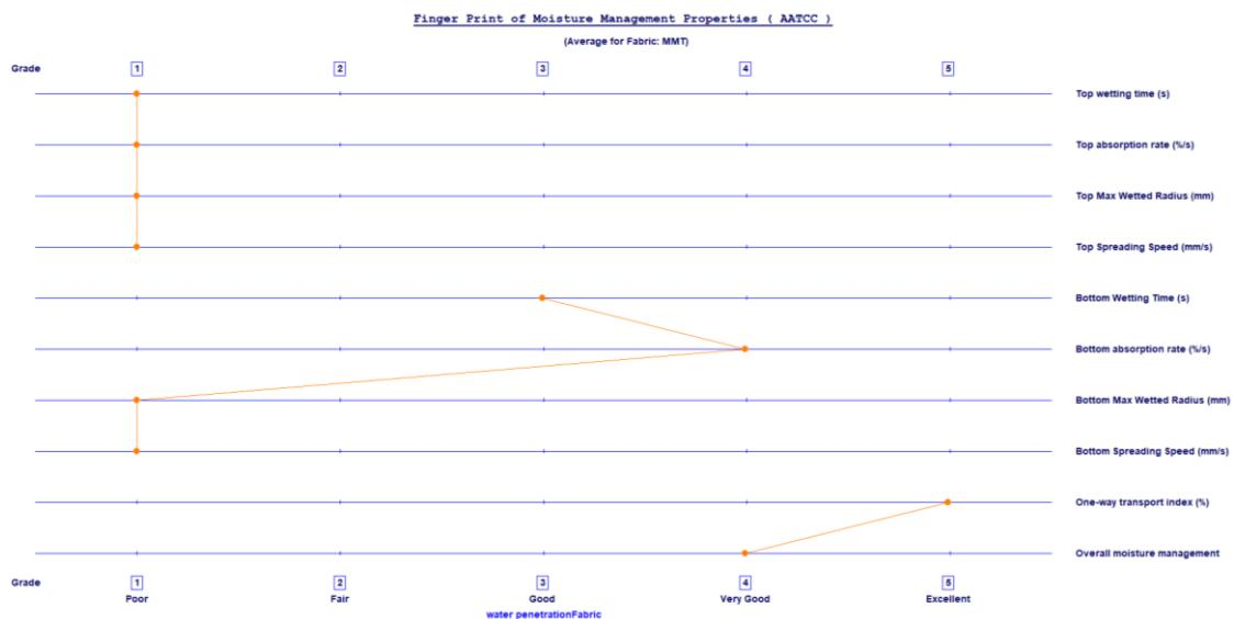
Slika 33. Fingerprint uzorka standardne poliesterske tkanine obradjenog u otopini enzima koncentracije 0,2 g/L, pH vrijednosti 7 te u vremenu obrade od 60 minuta
