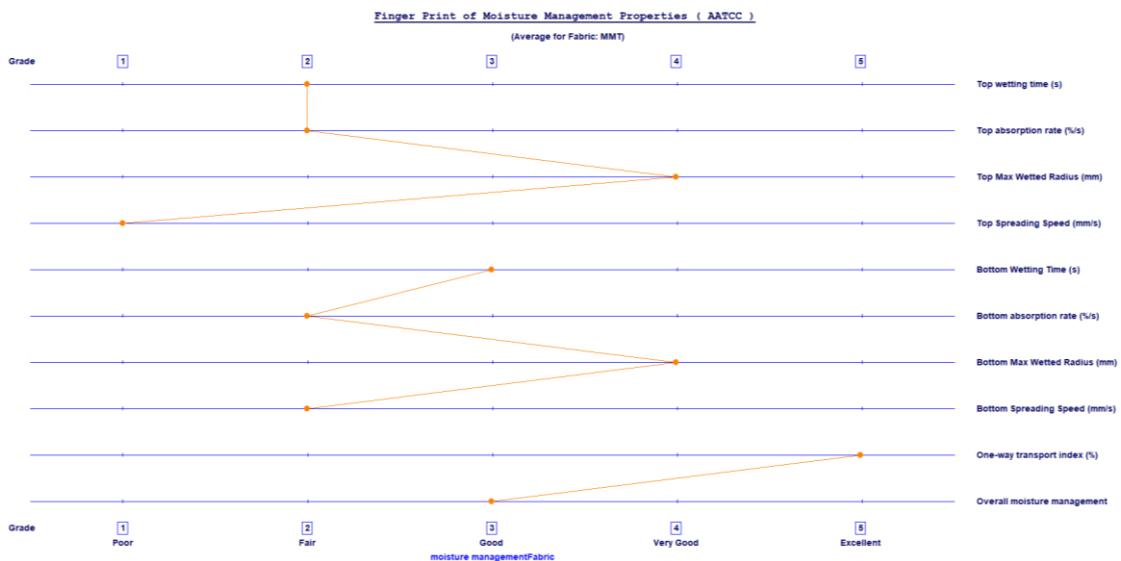
Slika 142. Fingerprint uzorka komercijalne poliesterske tkanine obradjenog u otopini enzima koncentracije 0,1 g/L, pH vrijednosti 7 te u vremenu obrade od 120 minuta
