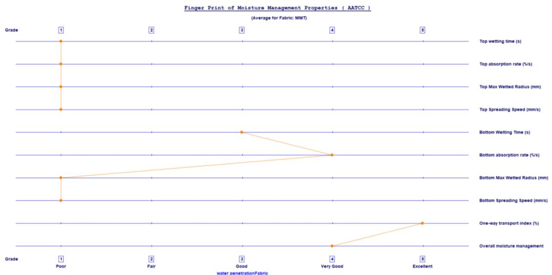
Slika 40. Fingerprint uzorka standardne poliesterske tkanine obradjenog u otopini enzima koncentracije 0,2 g/L, pH vrijednosti 9 te u vremenu obrade od 30 minuta
